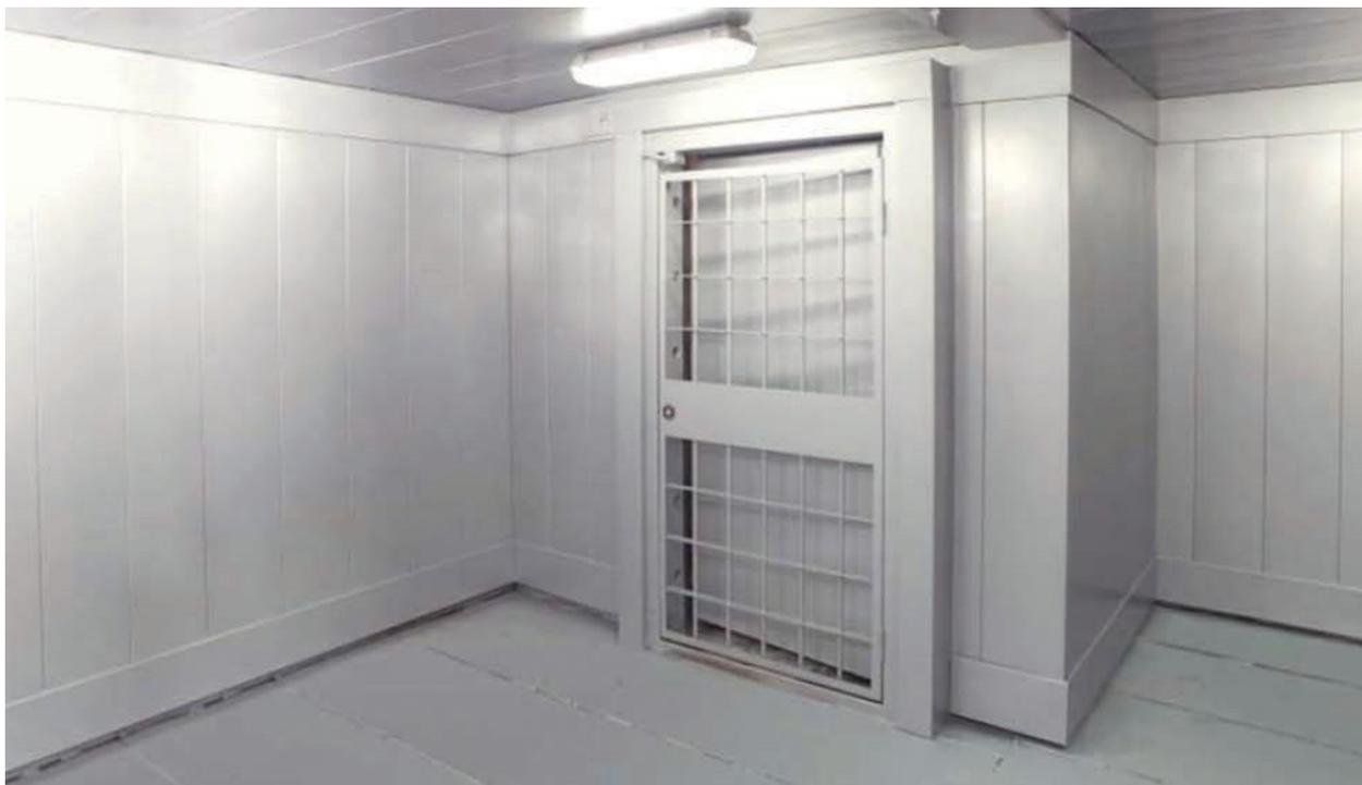
❏ I caveau delle banche sono progettati per immagazzinare oggetti preziosi con accesso autorizzato. Il caveau di una banca è composto da due elementi principali: conchiglia e blocco porta. Esistono tre tipi di scocca: monolitica, modulare, combinata.
